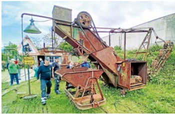
Anwendungsbeispiel: Schaufelbagger befüllt Lorenzug
